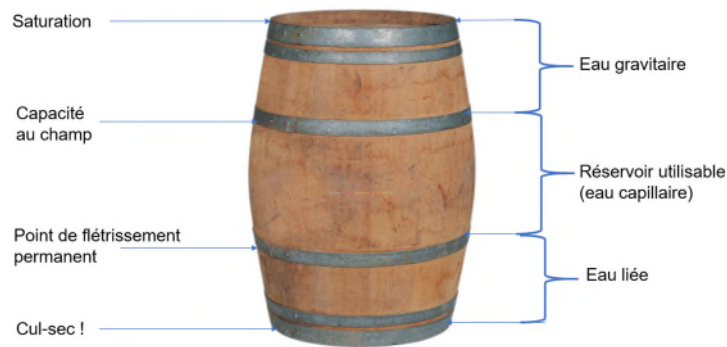
Figure 37 : Les seuils de contenu en eau du sol (à gauche) avec les types d'eau correspondants (à droite).
